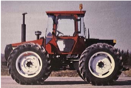
Der 1987 eingeführte H800 mit Rahmenlenkung war dank seiner Vielseitigkeit und der drehbaren Lenkconsole seiner Zeit voraus. Sein größter Nachteil war das noch unausgereifte hydrostatische Getriebe.
