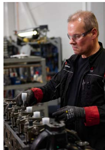
Techniker Petri Leskinen überholt einen wiederaufgearbeiteten Motor. Die neuen und wiederaufgearbeiteten Motoren von AGCO Power werden in Valtra Traktoren eingesetzt.
