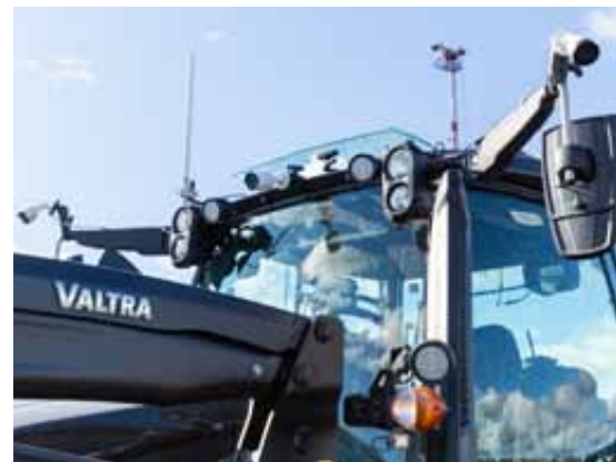
Außen angebrachte Kameras zeigen dem Fahrer, was um den Traktor herum geschieht.
