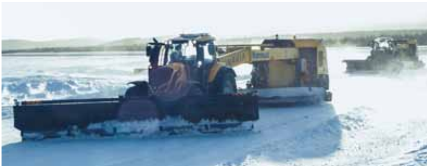
Die Traktorsteuerung befindet sich hier in einem Transporter. Es ist auch möglich, einen Traktor fernzusteuern, indem man die Steuerungen in einem anderen Traktor verwendet oder, mit größeren Einschränkungen, ein tragbares Steuergerät einsetzt.
